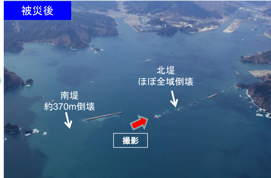
(撮影) 北堤の倒壊状況
